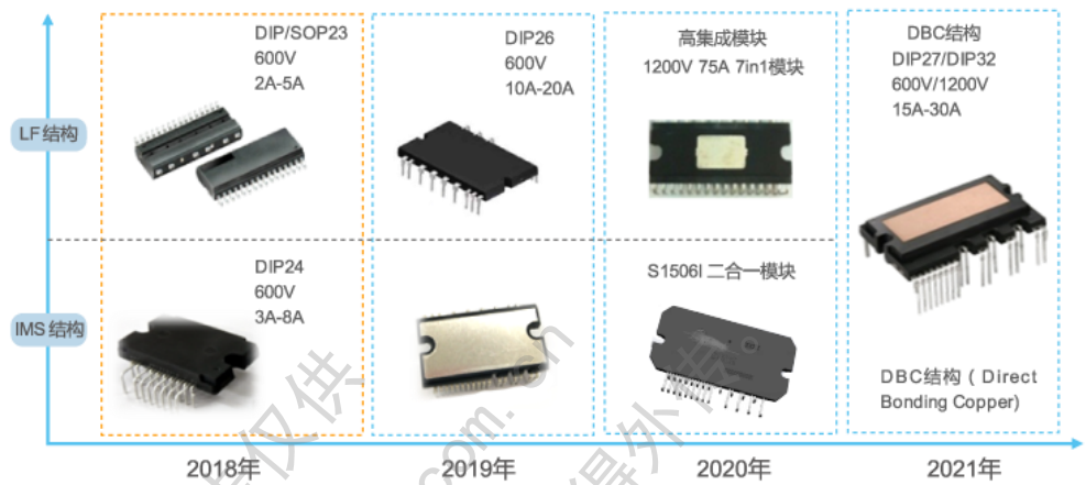
图表 56: 公司 IPM 功率模块封装工艺升级历程
